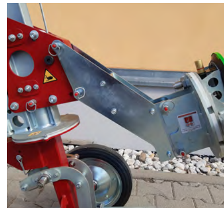
Die Verlängerung schräg nach unten ermöglicht einen größeren Arbeitsradius
