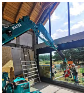
Der MK 1033 basiert auf dem MC 285 (siehe Seite 100) und kann über Vorsprünge und Balkone verheben
