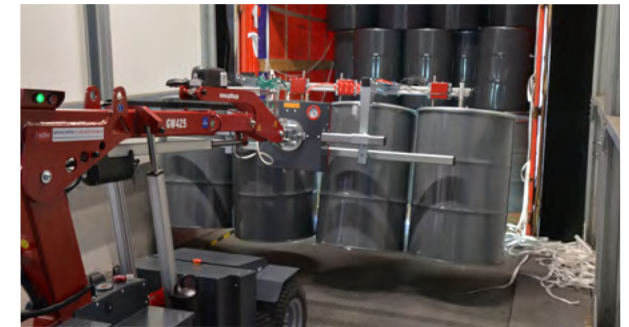
Der Fasssauger erkennt, wie viele Fässer angesaugt werden müssen und hebt diese mittels Vakuumtechnik.
