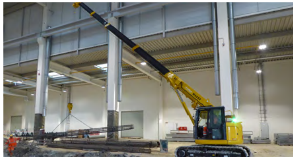
Die CC Modelle können auch als Pick & Carry Kran genutzt werden
