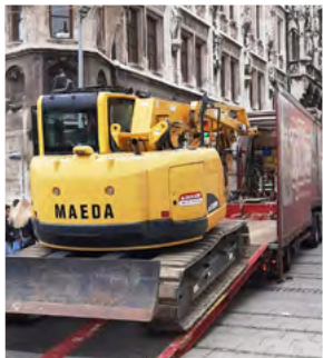
Die CC Modelle können auch als Pick & Carry Kran genutzt werden
