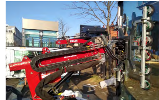
Cleveres Zubehör: Adapter für gebogene Scheiben für Lasten bis 500 kg
