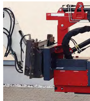
Verschiedene Adapter (z.B. Euroaufnahme) möglich zur einfachen und unkomplizierten Montage an diversen Arbeitsmaschinen wie Teleskopklader, uvm.
