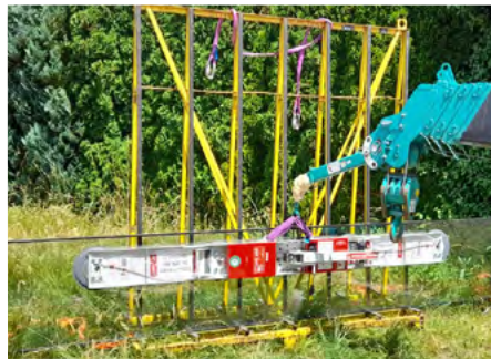
Mit einer Länge von 2,16 m ist der UPG 450 ideal für lange, schlanke Elemente geeignet
