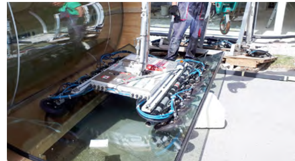
Der Hydraulikzylinder ermöglicht ein kontrolliertes Kippen des Vakuumsaugers – auch bei schweren Gewichten.
